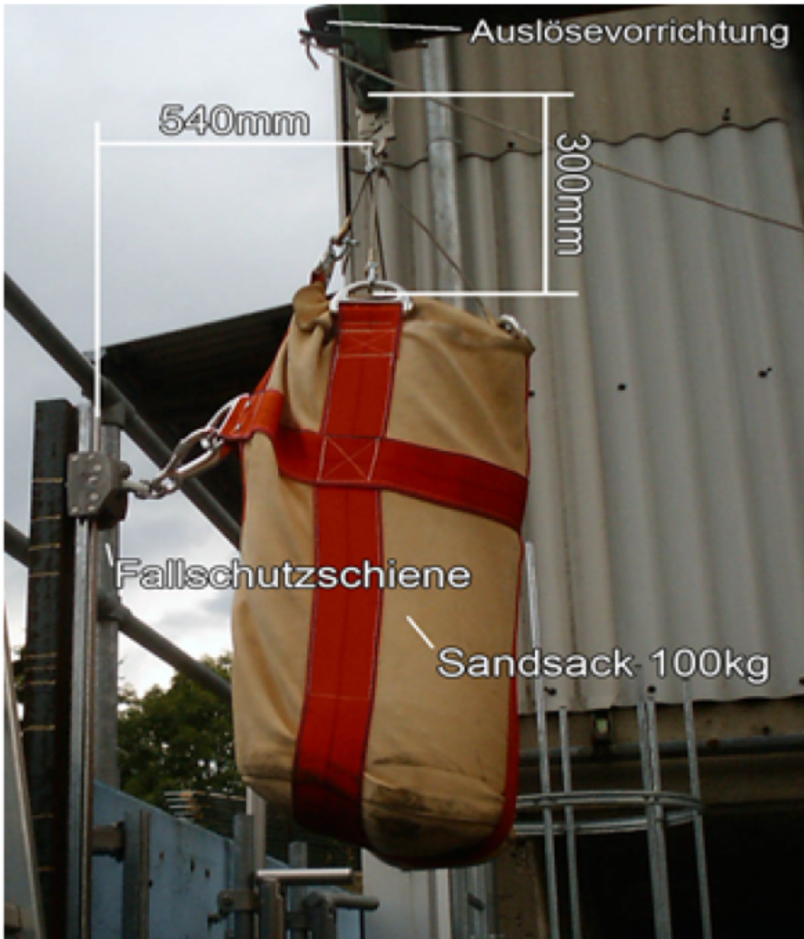
Abb1. Positionierung des Prüfgewichts
