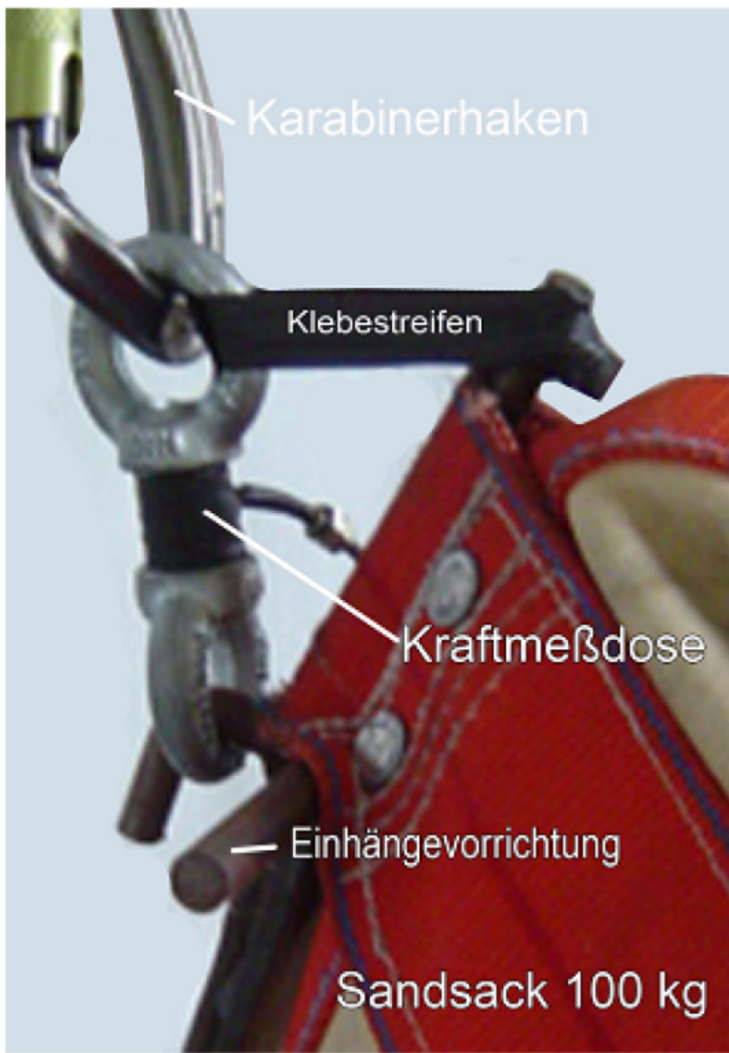
Abb1. Sandsack mit Einhängestange und Kraftmessdose
