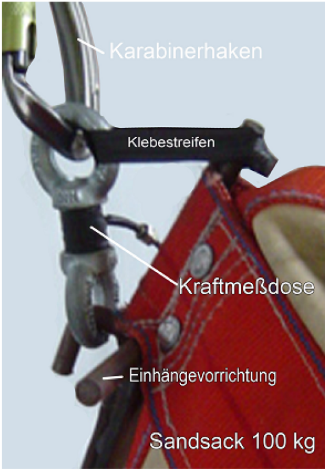
Abb1. Sandsack mit Einhängestange und Kraftmessdose
