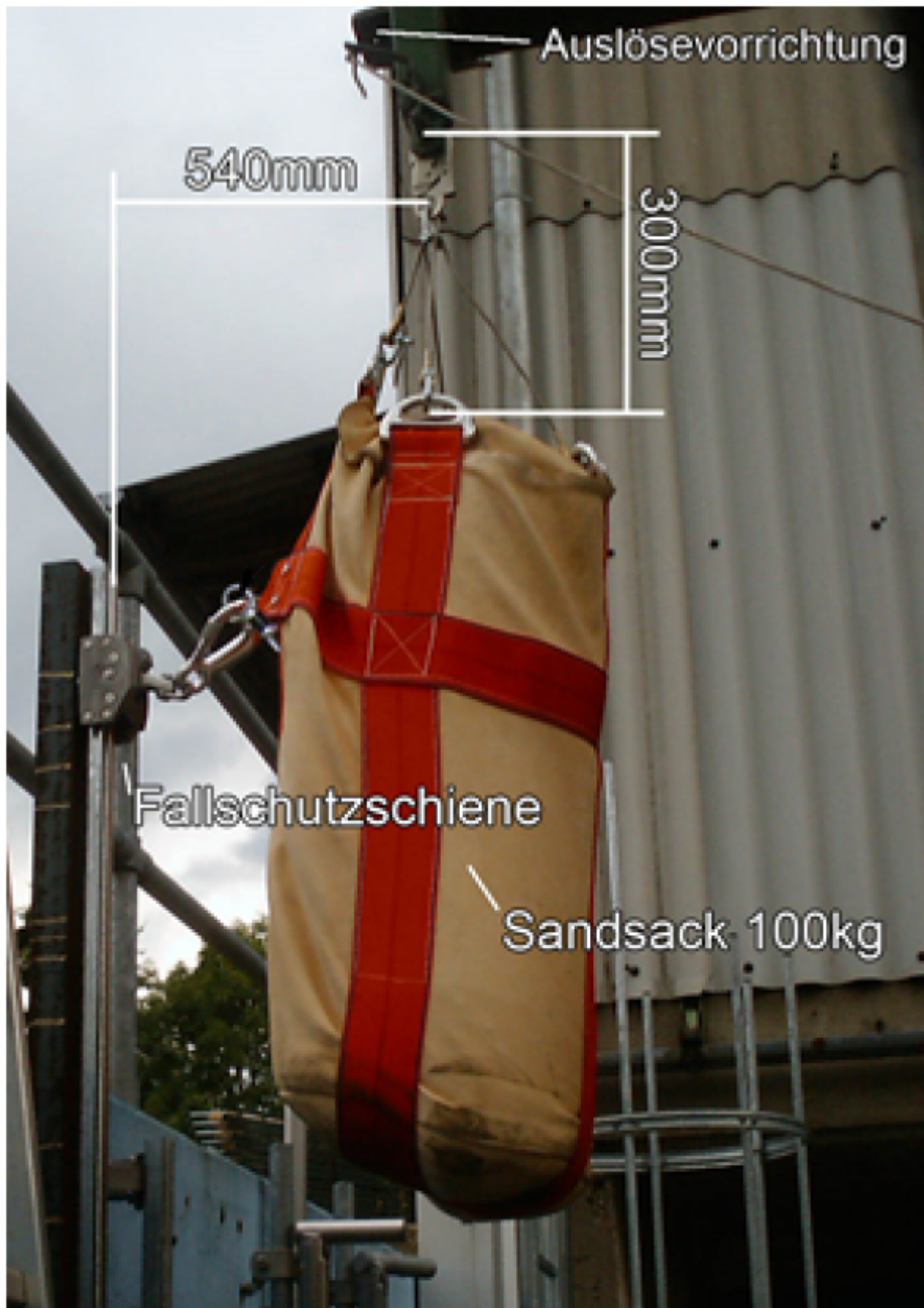
Abb2. Positionierung der Prüfgewichts
