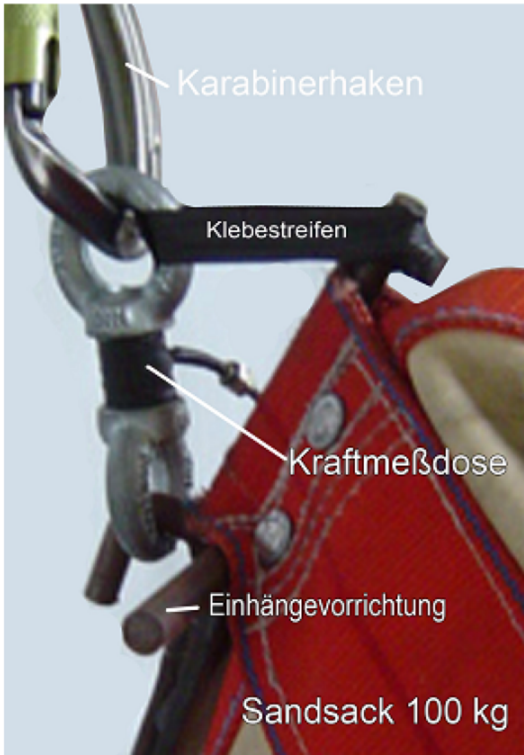
Abb1. Sandsack mit Einhängestange und Kraftmessdose
