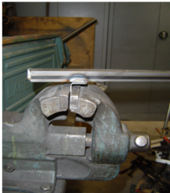
Bild Nr.2 Stufenwinkel durch verdrehen des Holmes zum Reißen bringen.
