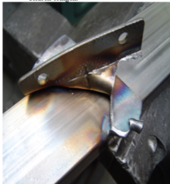
Bild Nr.4 Der Stufenwinkel ist gerissen.
