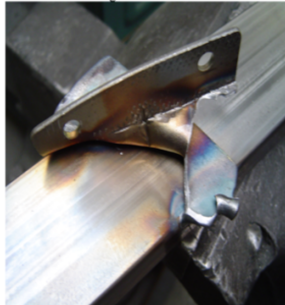
Bild Nr.4 Der Stufenwinkel ist gerissen.
