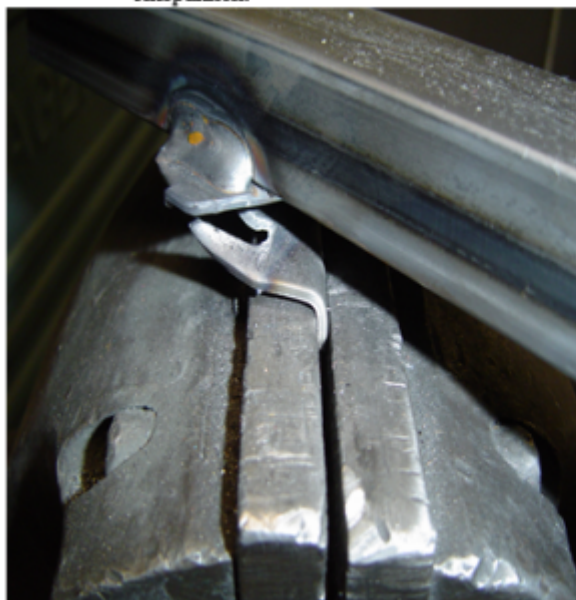
Bild Nr. 3 Die Schweißnaht bleibt unversehrt.
