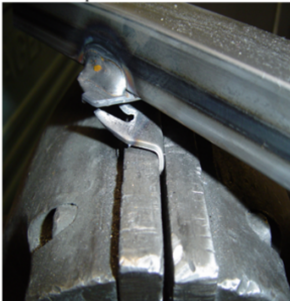
Bild Nr. 3 Die Schweißnaht bleibt unversehrt.
