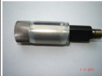
Bild Nr.6 Fertig geschrumpfter Schlauch.
