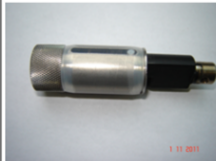
Bild Nr.6 Fertig geschrumpfter Schlauch.
