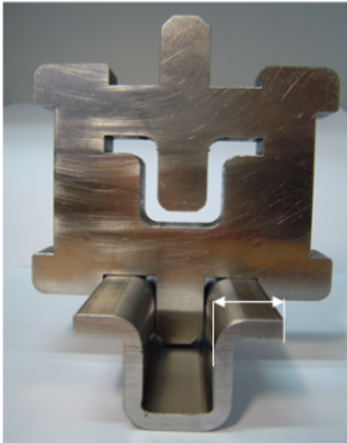
Bild Nr.2 Ermitteln Größt-/ Kleinstmaß, Flanschbreite.
