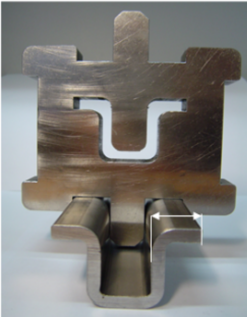
Bild Nr.2 Ermitteln Größt-/ Kleinstmaß, Flanschbreite.
