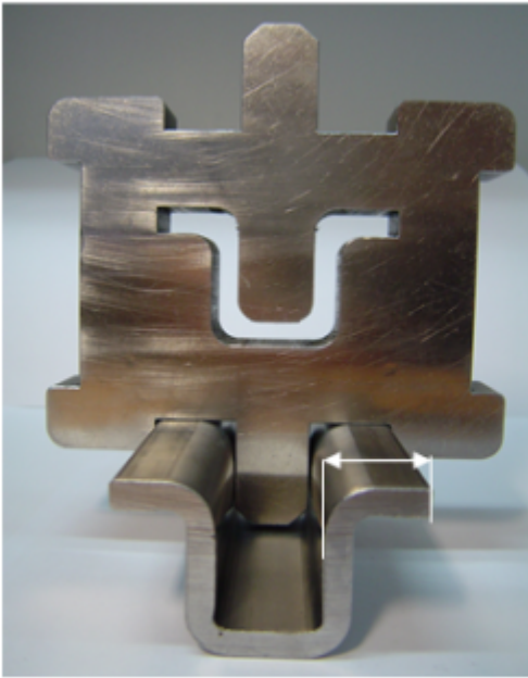
Bild Nr.2 Ermitteln Größt-/ Kleinstmaß, Flanschbreite.
