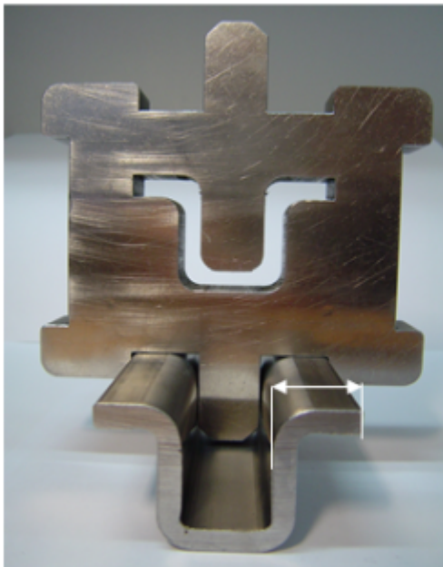
Bild Nr.2 Ermitteln Größt-/ Kleinstmaß, Flanschbreite.
