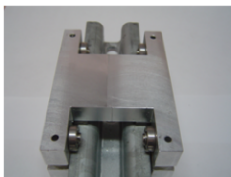
Bild Nr.4 Prüflehre über die gesamte Länge des Profils ziehen.
