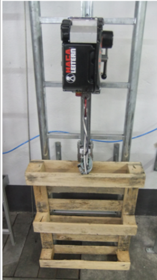
Abbildung 12: Vorrichtung für Klettertest
