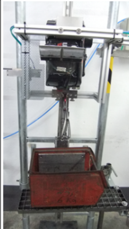
Abbildung 10: Vorrichtung für Aufwärtsfahrt mit Last
