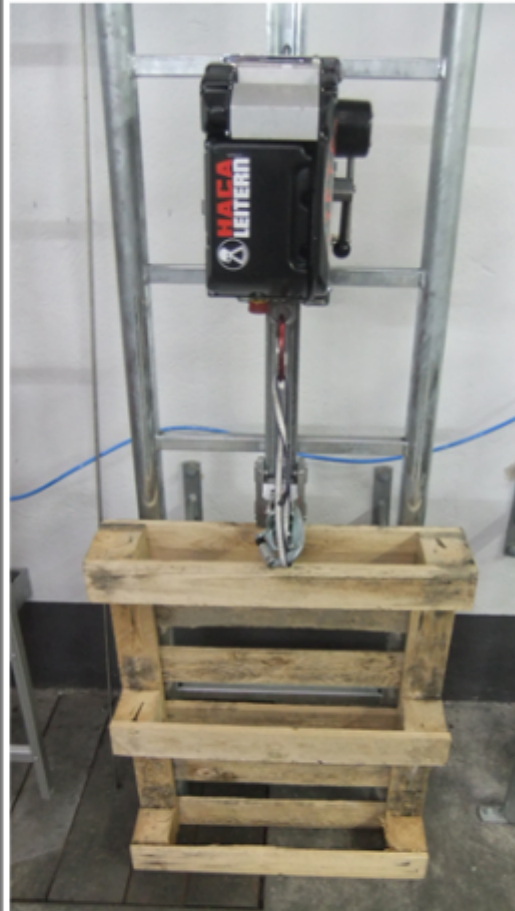
Abbildung 12: Vorrichtung für Klettertest
