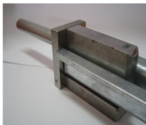
Bild Nr.3: Prüflehre bis zum Anschlag aufstecken.
