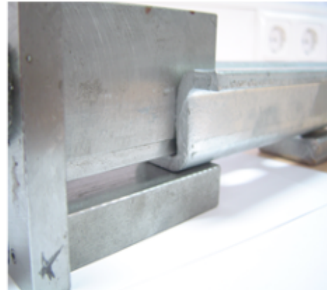
Bild Nr.2. Ansetzen der Prüflehre.
