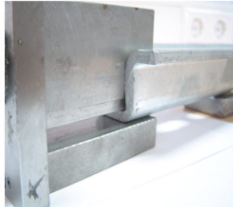
Bild Nr.2. Ansetzen der Prüflehre.
