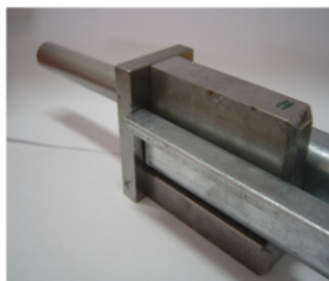
Bild Nr.3: Prüflehre bis zum Anschlag aufstecken.
