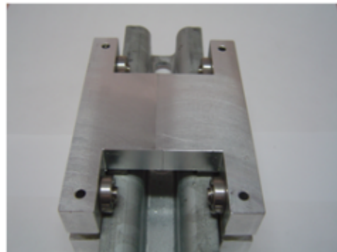
Bild Nr.4 Prüflehre über die gesamte Länge des Profils ziehen.
