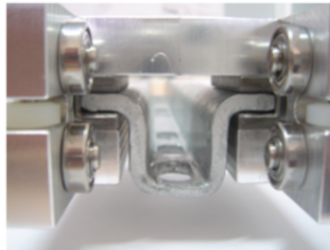
Bild Nr.3 Prüflehre- Aufschieben.
