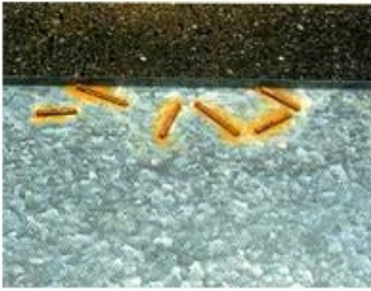
Abb. 4: Reste von Schweißelektroden können sog. "Fremdrost" verursachen
