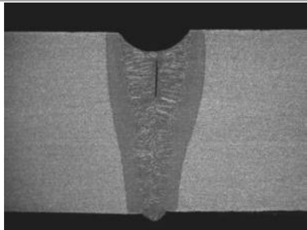
Bild 11: Interdendritischer Lunker einer Elektronenstrahlschweißnaht
