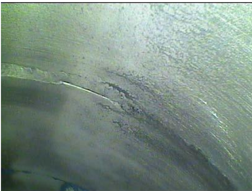
Bild 12. Bindefehler zur Oberfläche hin offen
