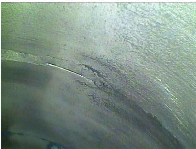
Bild 12. Bindefehler zur Oberfläche hin offen
