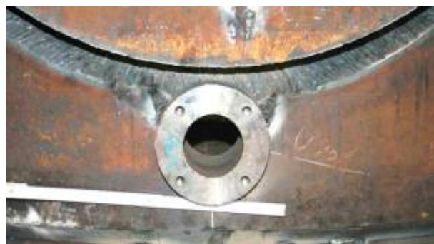
Bild 2: Nahtvorbereitung mangelhaft..... Bild 3: Nahtvorbereitung mangelhaft, Schweiß- und Zusammenbaufolge nicht beachtet.
