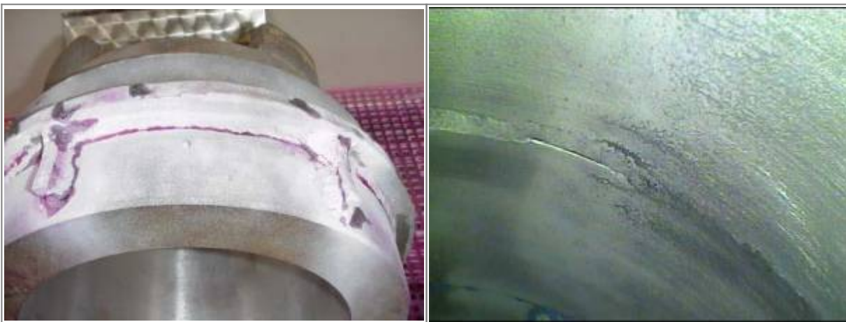
Bild 12. Bindefehler zur Oberfläche hin offen
