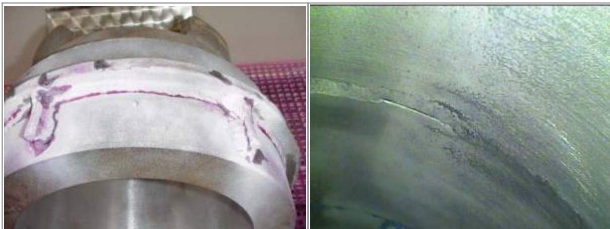
Bild 12. Bindefehler zur Oberfläche hin offen
