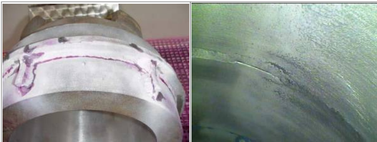
Bild 12. Bindefehler zur Oberfläche hin offen
