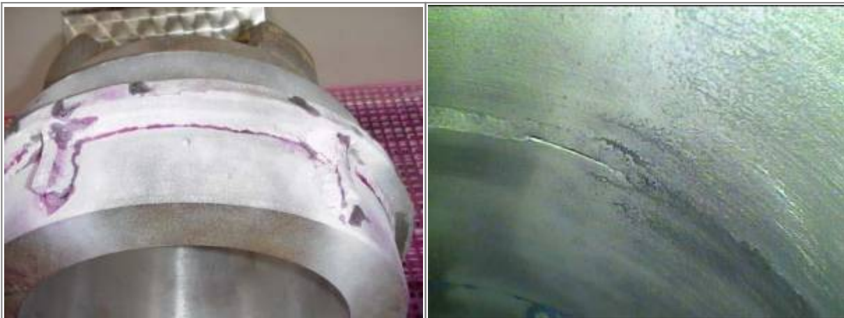
Bild 12. Bindefehler zur Oberfläche hin offen
