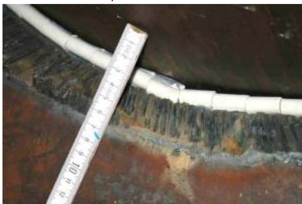
Bild 2: Nahtvorbereitung mangelhaft..... Bild 3: Nahtvorbereitung mangelhaft,
