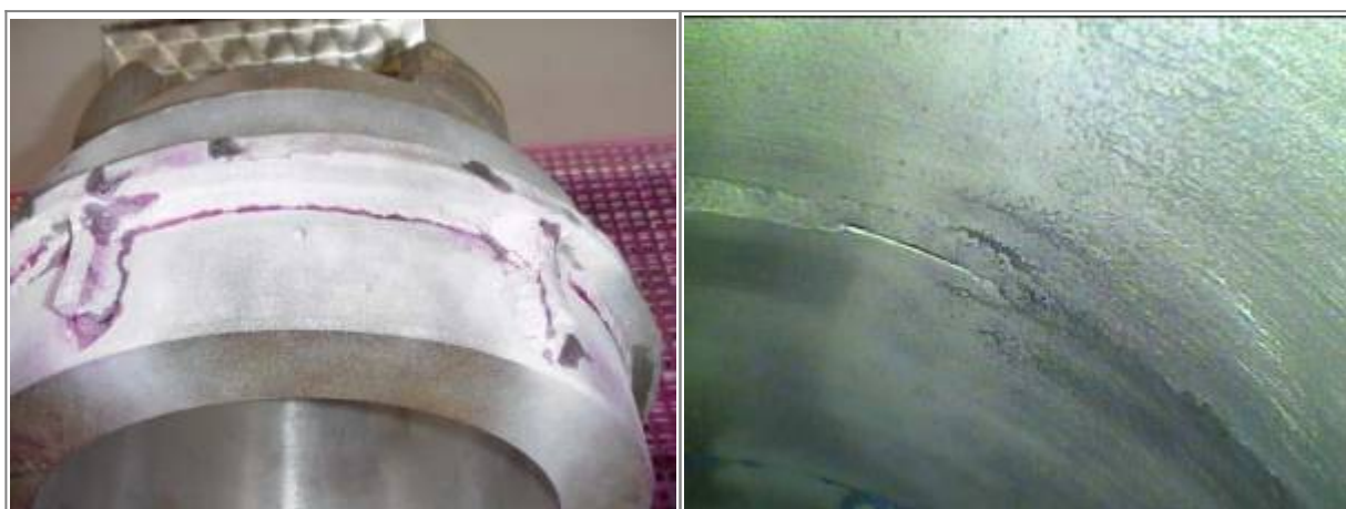
Bild 12. Bindefehler zur Oberfläche hin offen
