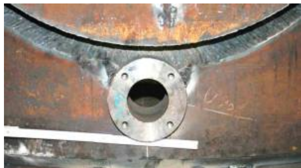
Bild 2: Nahtvorbereitung mangelhaft..... Bild 3: Nahtvorbereitung mangelhaft,
