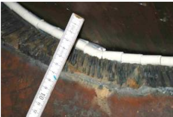
Bild 2: Nahtvorbereitung mangelhaft..... Bild 3: Nahtvorbereitung mangelhaft,
