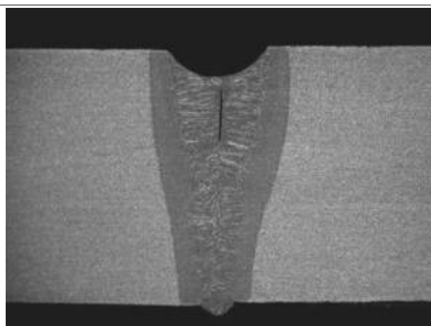
Bild 11: Interdendritischer Lunker einer Elektronenstrahlschweißnaht
