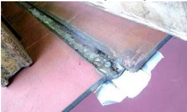
Bild 4: Sichtprüfung während des Schweißens, Riss in
