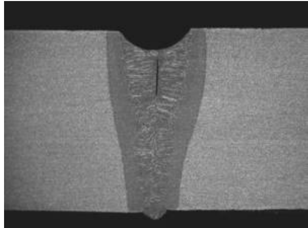
Bild 11: Interdendritischer Lunker einer Elektronenstrahlschweißnaht
