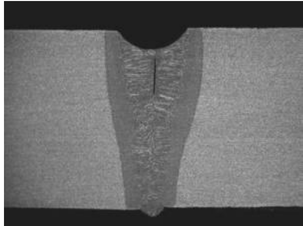
Bild 11: Interdendritischer Lunker einer Elektronenstrahlschweißnaht
