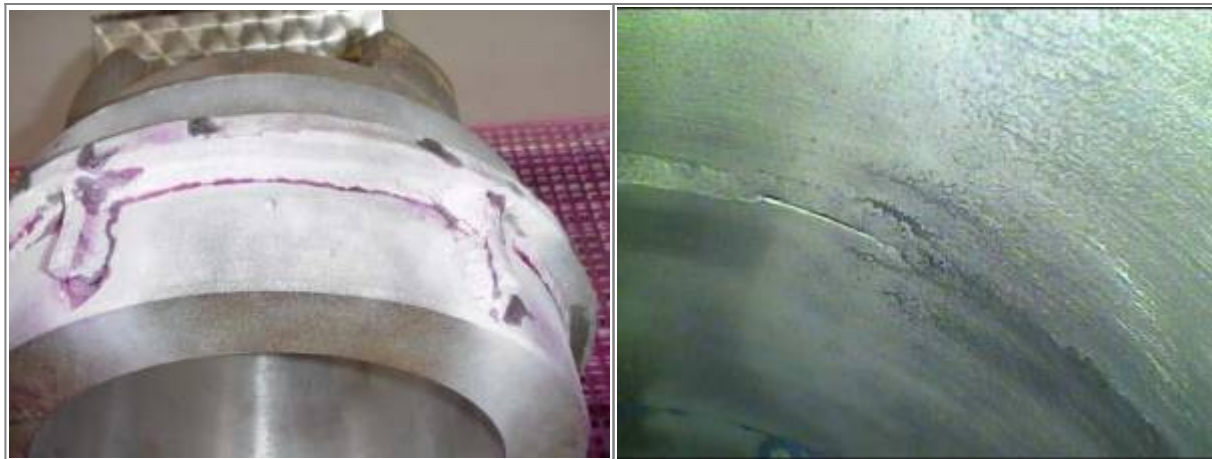
Bild 12. Bindefehler zur Oberfläche hin offen
