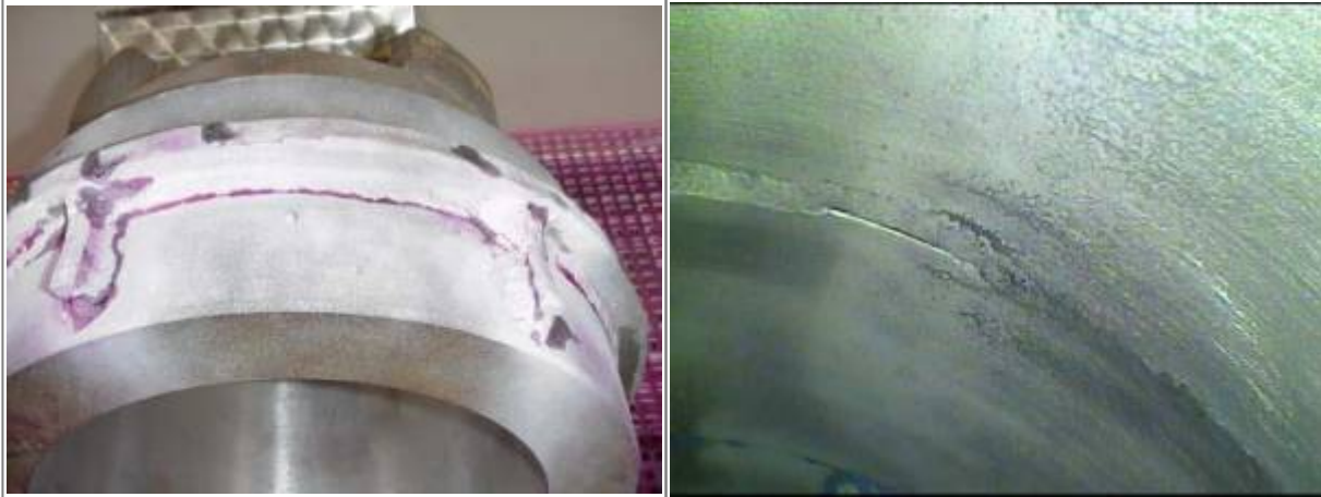
Bild 12. Bindefehler zur Oberfläche hin offen
