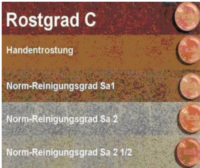
Bild 4: Versch. Vorbereitungsgrade bei Ausgangszustand C
