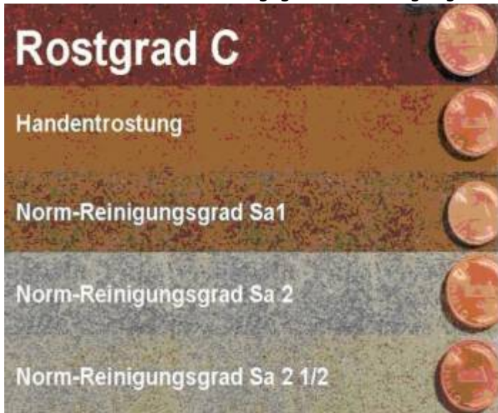
Bild 4: Versch. Vorbereitungsgrade bei Ausgangszustand C
