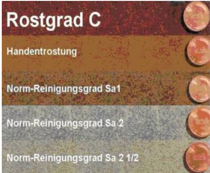
Bild 4: Versch. Vorbereitungsgrade bei Ausgangszustand C
