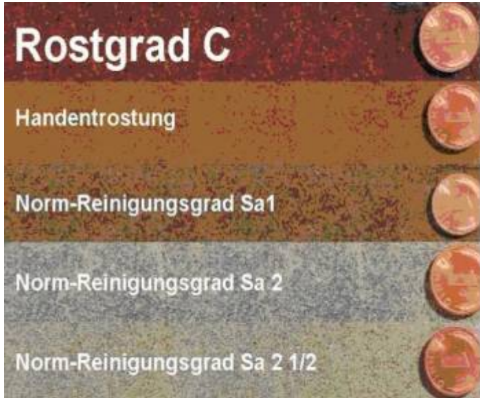
Bild 4: Versch. Vorbereitungsgrade bei Ausgangszustand C
