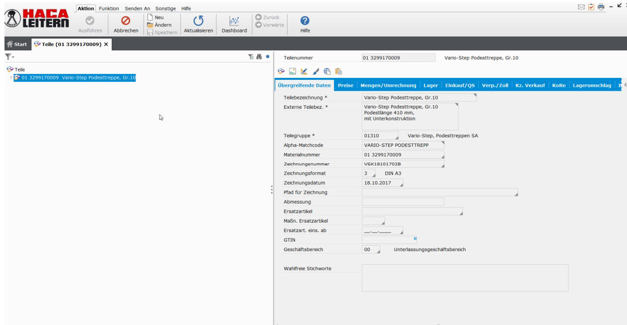
Bei den Vario's werden alle Zeichnungen (Kundenzeichnung, Aufstieg, Podest und Unterkonstruktion) als pdf im Ordner Zeichnungen Produktion unter der VSK18101702B.pdf abgespeichert. Hier kann dann die Fertigung auf alle Zeichnungen zugreifen.
