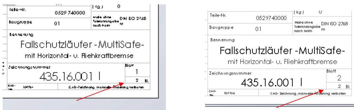
Bei Zeichnungen wo auf der zweiten Seite ein Laserteil mit einer 53er Nummer ist, wird die Zeichnungsnummer mit einem Zusatz(- und die Seite auf der die 53er Nummer ist) ergänzt.
