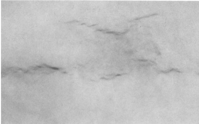
Fig. 15-8. Hot cracks (hot tears)
