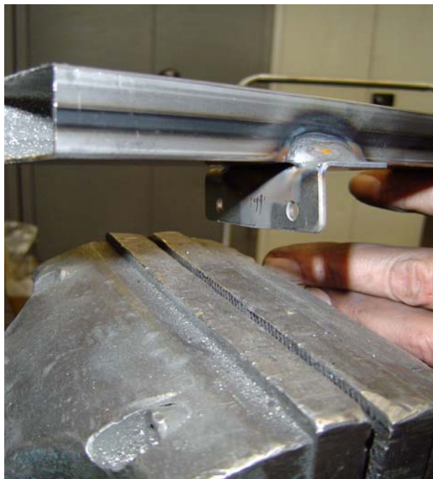
Bild Nr.1 Holm am Stufenwinkel in den Schraubstock einspannen.
