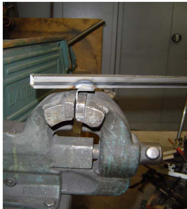
Bild Nr.2 Stufenwinkel durch verdrehen des Holmes zum Reißen bringen.
