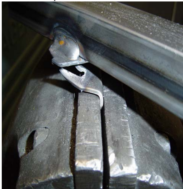
Bild Nr. 3 Die Schweißnaht bleibt unversehrt.
