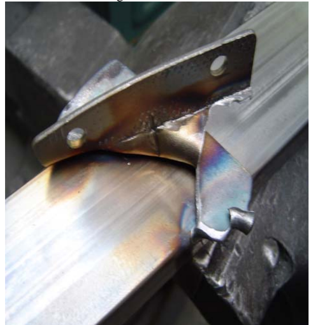
Bild Nr.4 Der Stufenwinkel ist gerissen.
